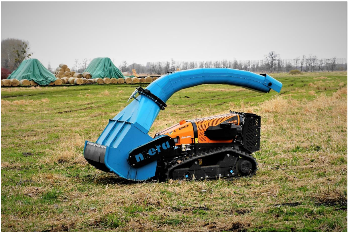
Abb. 3: Kleinere, funkgesteuerte Moorraupe (Foto: Juliane Petri)
