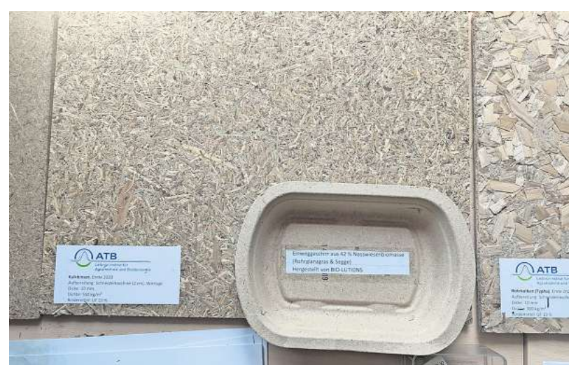
Aus Kalkbinsen und Rohrglanzgras können Platten und Einweggeschirr hergestellt werden.
