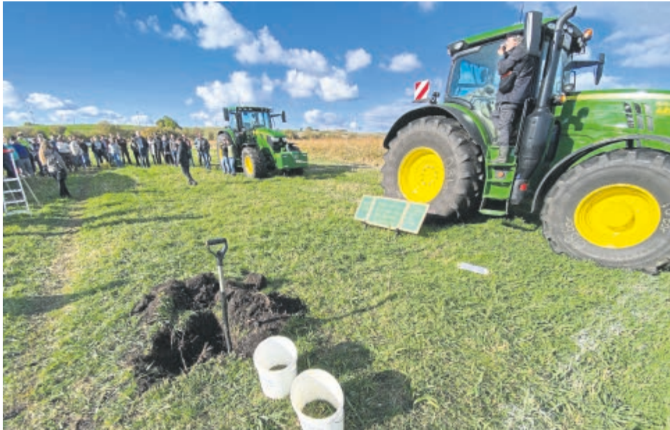
Vorführung mit Zug- und Bremstraktor auf dem Moortag in Brandenburg. Ein niedriger Reifendruck und ein fachkundiger Fahrer sparen Diesel und schützen den Boden.
