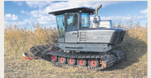
Leichte Moorraupe , vorgeführt von Maschinenbauer und Lohnunternehmer De Vries aus den Niederlanden. In einem Arbeitsgang wird gemäht und geschwadet. FOTOS: LUDWIG VOLK
